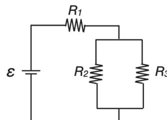
Sabendo que a corrente que passa por  $R_3$  é 2,0 mA, qual é, em volts, a voltagem da fonte?
